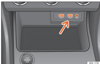
**Fig. 247** Centre console: USB/AUX-IN input.
